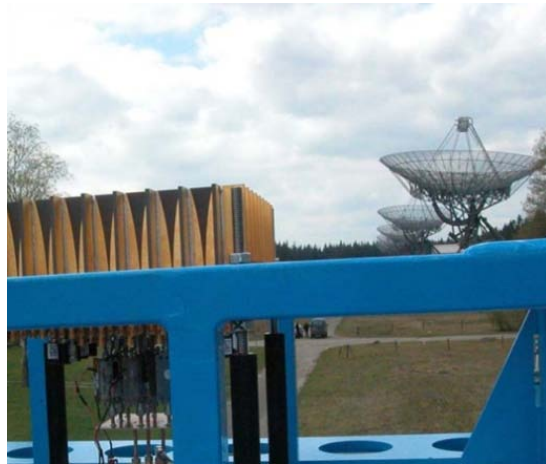
图 12 安装于 WSRT 的 FARADAY 常温 PAF
