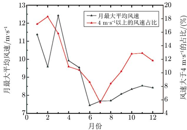
图 7 月最大平均风速与大于  $4 \text{ m} \cdot \text{s}^{-1}$  的风速占比
