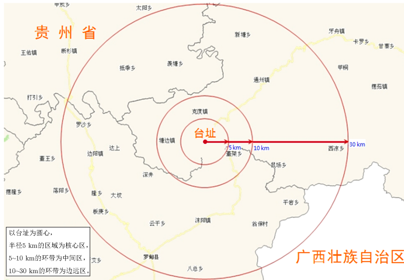
图2 FAST电磁波宁静区示意图
