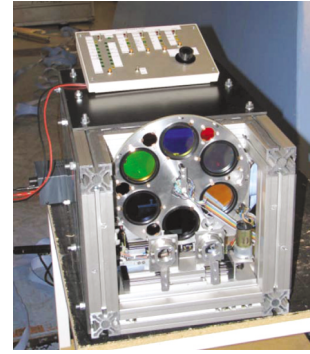
图 4 2005 年 11 月研制的幸运成像系统 LuckyCam [34]
