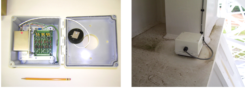
图 10 GBT 温度传感器和变压器及安装布线示意图 [19]
