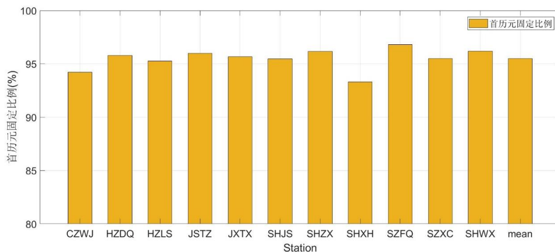
图 6-10 各测站仿动态 PPP-RTK 固定解首历元固定比例
