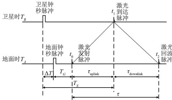
图1 星地激光时间比对<sup>[22]</sup>
