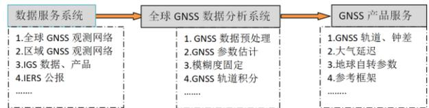
图1 GNSS高精度定轨定位系统流程图
